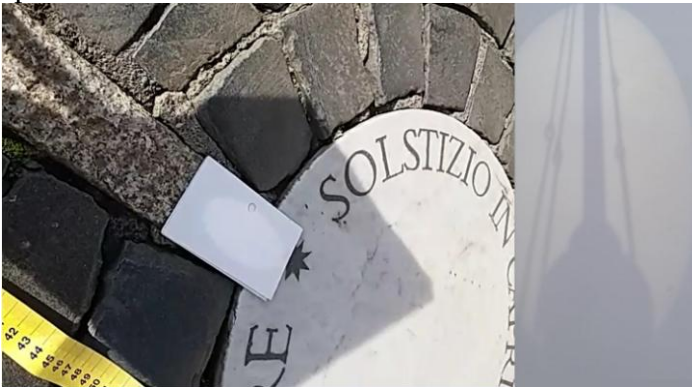
Fig. 5 Sole proiettato il 19 dicembre 2022 sulla meridiana di s. Pietro. Centro della lente del cannocchiale a 31 cm di altezza sulla meridiana e 66 cm di distanza verso l'obelisco, dalla stella nera del Capricorno. La proiezione in meridiano è a destra, col Sole dietro il profilo della base della croce sommitale.
