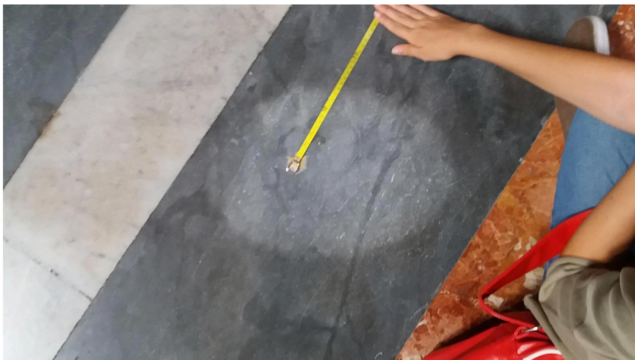
Fig. 4 Sull'origine del metro disposto lungo la linea dell'equatore c'è la stella equatoriale posta a 1h 30 m dal transitto meridiano, cioè a 22.5^\circ dall'azimut 180^\circ che è il Sud. La foto è del 23 settembre 2019 ore 11:32:22, il transitto sulla meridiana è accaduto alle 13:02:43.8 mentre le effemeridi lo calcolano alle 13:02:27.9. La meridiana sappiamo che è globalmente deviata verso Est di circa 5', la linea dell'equatore risulta ruotata di 13' verso Sud, ma la stella è centrata dal Sole con una precisione di 5 secondi, compatibile con un disallineamento della meridiana di riferimento originale di poco più di 1.6'.
