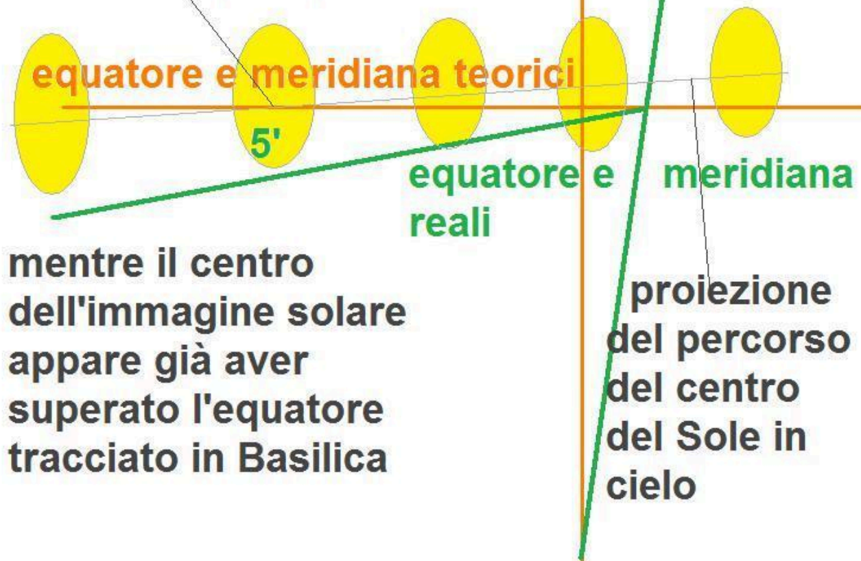
Fig. 6 schema della rotazione dell'equatore rispetto a quello teorico e della meridiana rispetto a quella teorica. Le due rotazioni sono entrambe di 5', ma una è in senso opposto all'altra. L'azimut delle stelle collocate sulla linea dell'equatore, invece è preciso al minuto d'arco (come si evince dall'immagine in figura 3) rispetto alla meridiana teorica.
